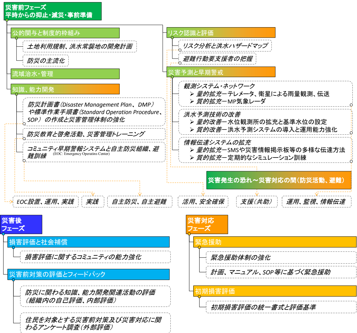
図 10-2 各フェーズにおける主な非構造物対策の活動分野と主な対策
