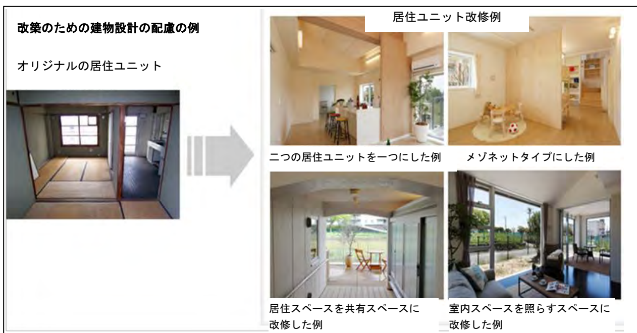
図 5-3 改築のための建物設計の配慮の例
