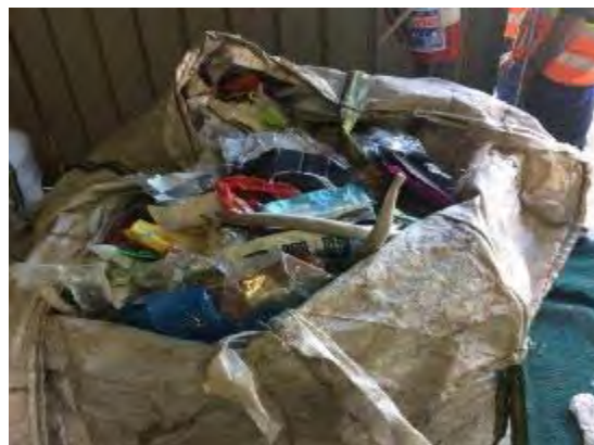
1回当たり3箇所からテーリング材を採取。各サンプルは、50kg程度。
