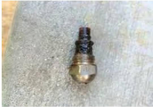
バーナーノズルに汚れが付着した為洗浄
