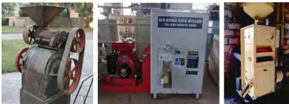
図 2-1-14 ナイジェリアで入手可能な小型精米機、左：エンゲルバーグ式精米機（インド、中国製）、中：小型摩擦式精米機（韓国製）、右：ワンパス型精米機（インドネシア製）
