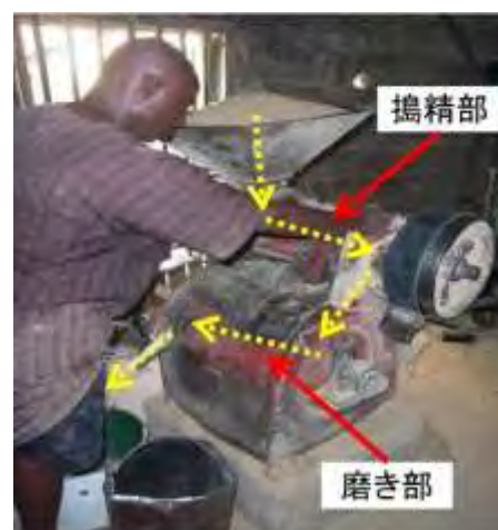
図 2-1-15 エンゲルバーグ式精米機では搗精 2 回、研磨 1 回
