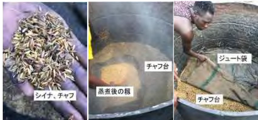
図 2-1-12 パーボイル加工業者が工夫している中底としてのチャフ台
