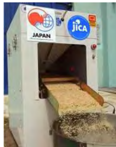
図 2-1-16 ナイジェリアで入手可能な韓国製の石抜き機
