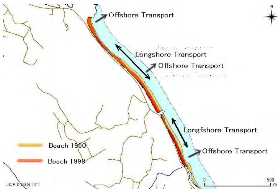
図 4-2-2 ノース・イースト・ポイントにおける推定される漂砂移動
