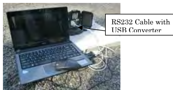
図 2-5-6 雨量計と PC の接続
