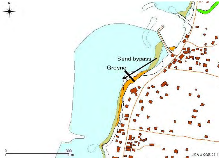
図 4-2-8 ラ・バッセの海岸保全対策
