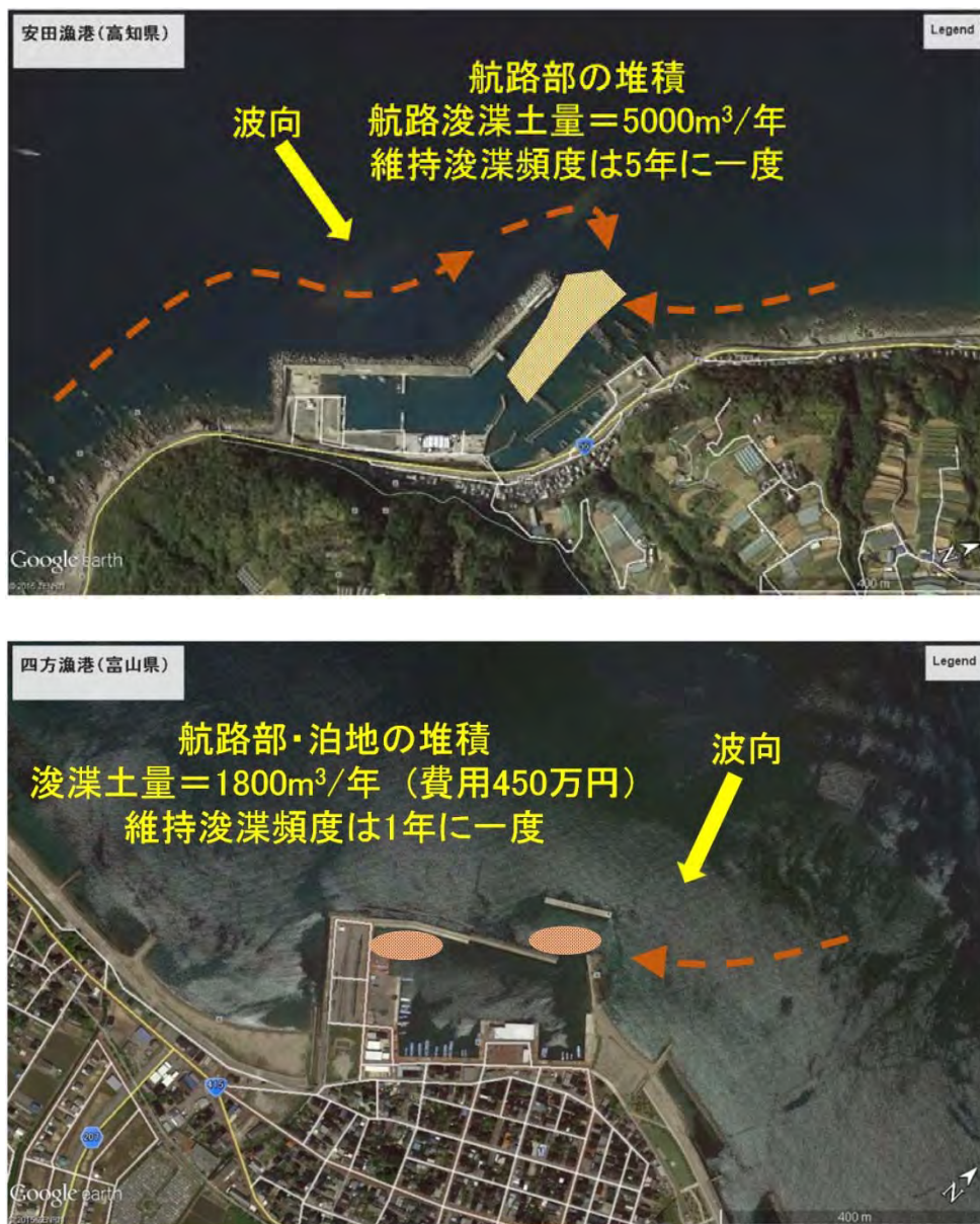
図 4-18 日本国内の漁港の堆砂事例：安田漁港 (高知県：上図)、四方漁港 (富山県：下図)
