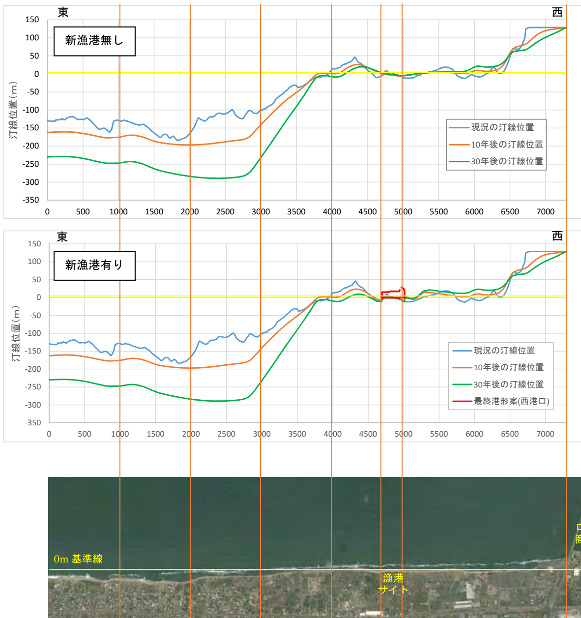
図 4-19； 漁港新設による広域の汀線変化予測：10年後と30年後 カタंगाから新漁港サイト付近の汀線位置を0mとしたときの汀線位置の変化
