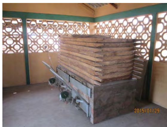
図 1-21: 炭を燃料とした燻製窯
