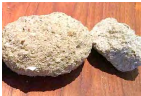
図 2-22:ロメ港3号岸壁の海底-12m で採取された海底岩礁、ビーチロックの試料
