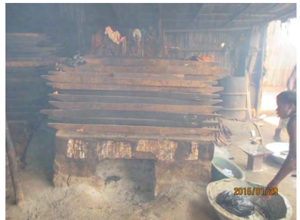
燻製窯 ブロックやレンガで作られている。窯の上に木枠に金網を張ったものを積み重ね、手火山と呼ばれる。30分ごとに上下段を入れ替え製品にムラができるのを防ぐ
