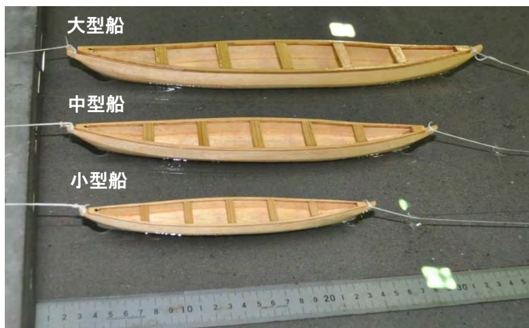
図 2-19； ピローグ模型（模型スケール、縦係留）
