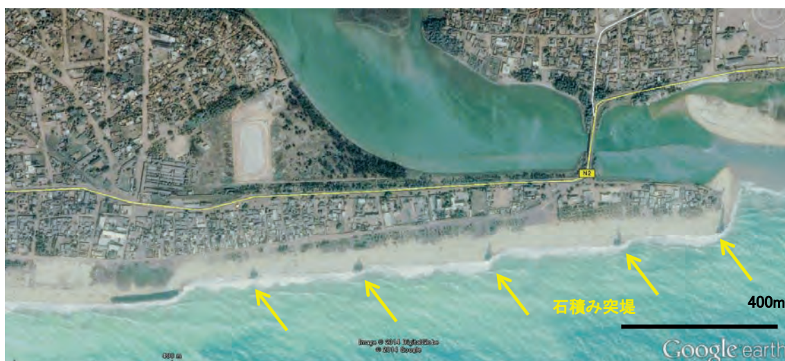
図 1-16: アネホ(ロメ自治港の東 36km)における海岸侵食対策工(石積み突堤)
