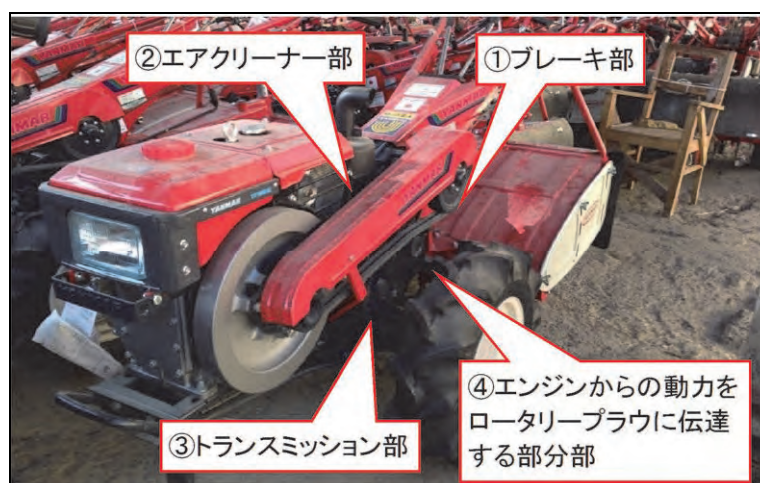
図 2-14 ヤンマー製耕耘機不具合箇所
