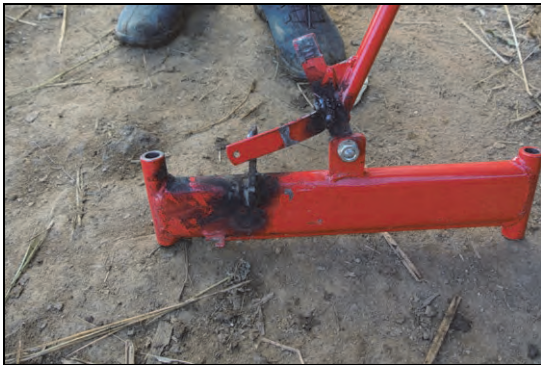
写 13 溶接による修理が必要な際は AMC、RAMC で修理が可能。
