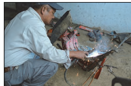
プラウを溶接中のメカニック
