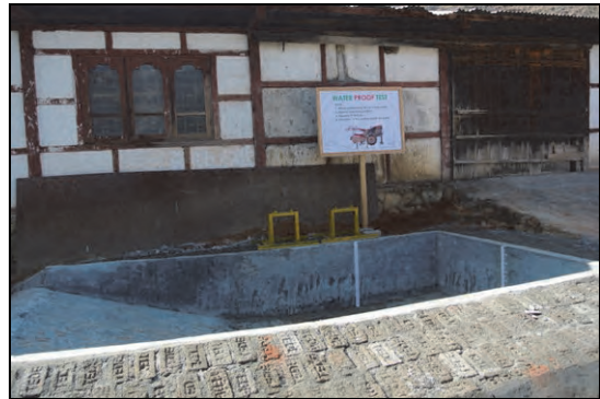
写14 耕耘機は AMC パロで性能試験を実施している。(写真は耐水試験施設)
