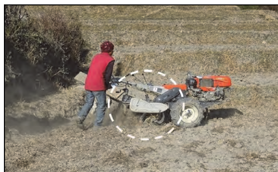
耕起後の破砕（Rotovating） 掘り起こした土をロータリーで砕く
