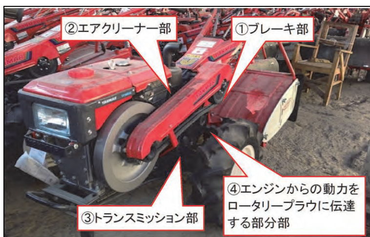
図 2-14 ヤンマー製耕耘機不具合箇所
