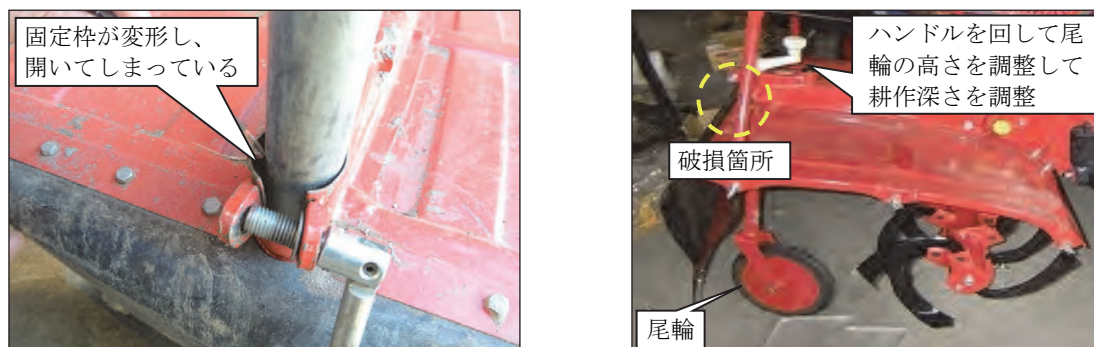
図 2-21 尾輪高さ調整部分
