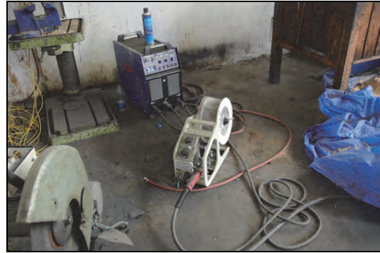
バジヨ RAMC の整備機材（半自動溶接機）
