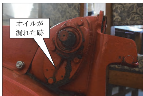
図 2-18 エンジンからロータリープラウへ動力を伝えるギア部分
