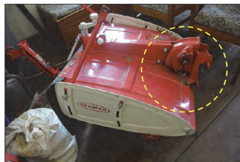
図 2-18 エンジンからロータリープラウへ動力を伝えるギア部分
