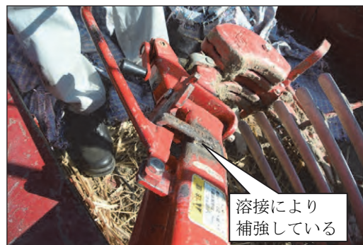
図 2-19 シングル・リバーシブルプラウの破損箇所
