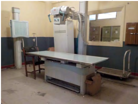
単純撮影用X線装置（日本製、機齢約4年）フラット・パネ ル・ディテクターでフィルム・レス撮影を行っている。
