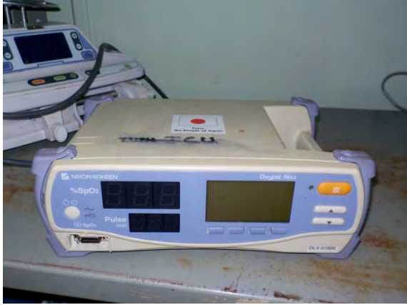
パルスオキシメーター（日本製） 集中治療室で患者の酸素血中濃度の管理に使用している。
