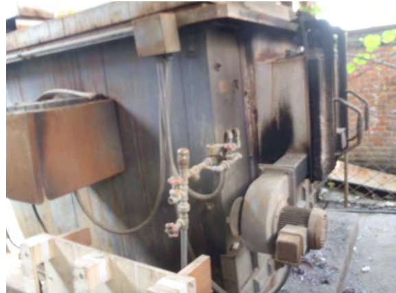
焼却炉。老朽化が著しく進んでおり故障が頻発。修理を繰り返しながら使用している。
