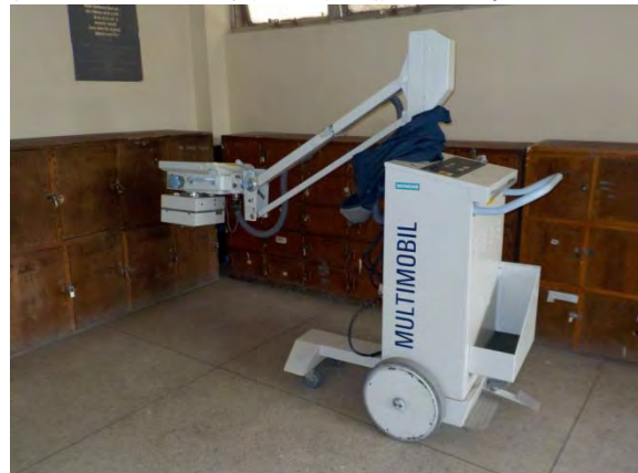
回診型X線装置（シーメンス社製、機齢4年） 移動が困難な入院患者を病棟内で撮影する際に使用。
