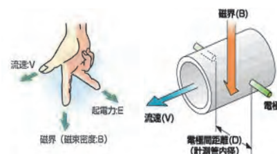
図 2-2 フレミングの右手の法則と 電磁誘導作用
