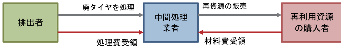
図 14 日本における処理費を必要とする廃棄物処理市場のメカニズム
