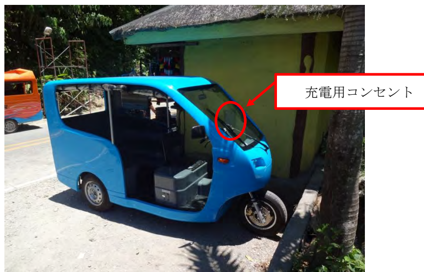
図 3.15 電動トライスクルの設置状況
