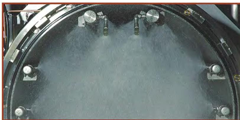
●理想的な加熱:均一な加熱を極限まで追求した新熱水噴流方式の採用により、安全な商品を供給できます。
