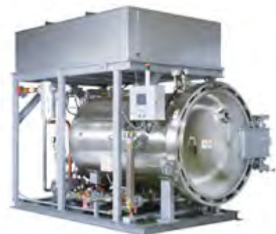
㈱サムソン製の調理殺菌装置。パックに入れたまま、食材の加熱調理と殺菌が可能
