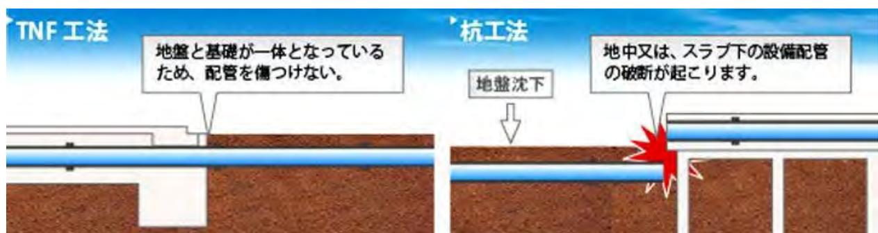
図 2-3 設備配管の破断防止メカニズム
