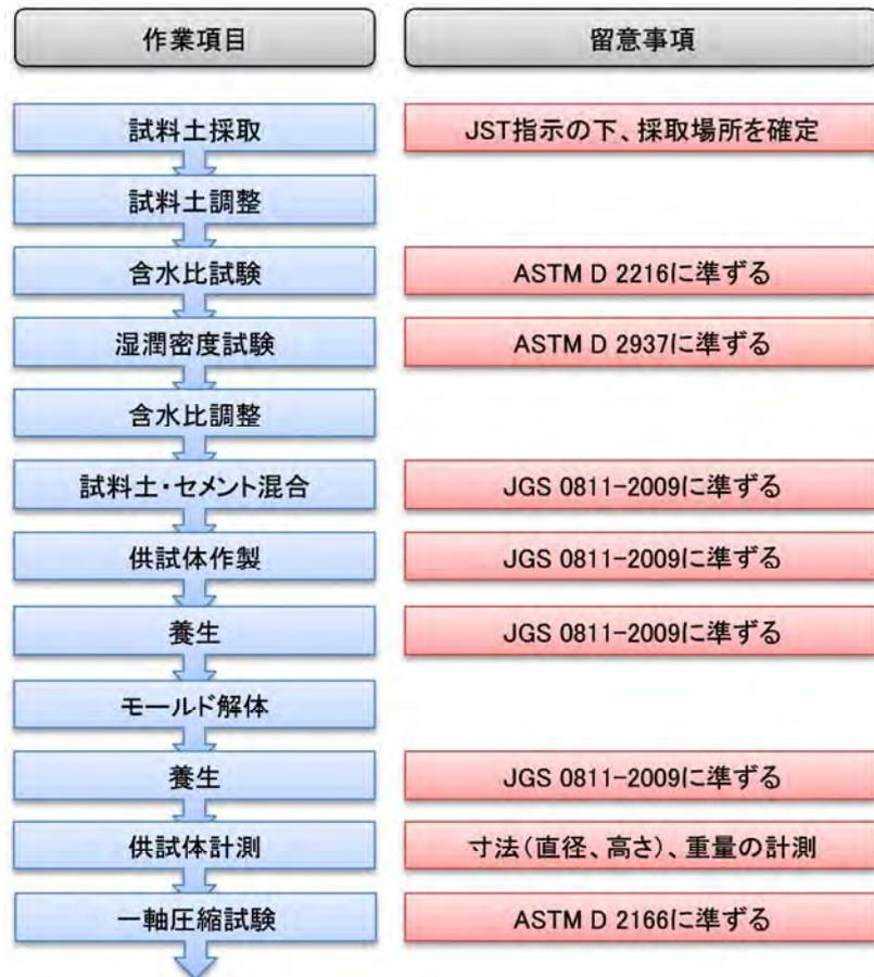
図 3-1 セメント混合試験手順
