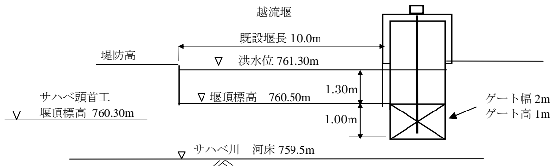
図 3-2-4 洪水放流工の改修計画図
