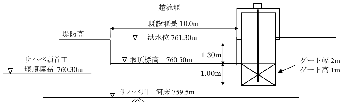
図 3-2-4 洪水放流工の改修計画図
