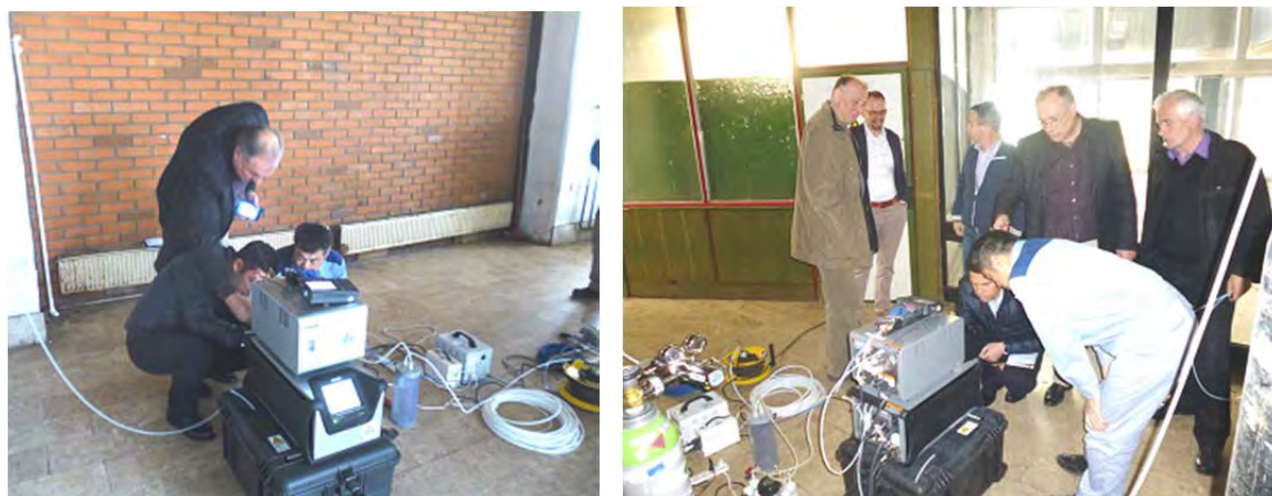
写真4-8 C/Pメンバによる連続分析計スパン調整 (校正調整) の様子
