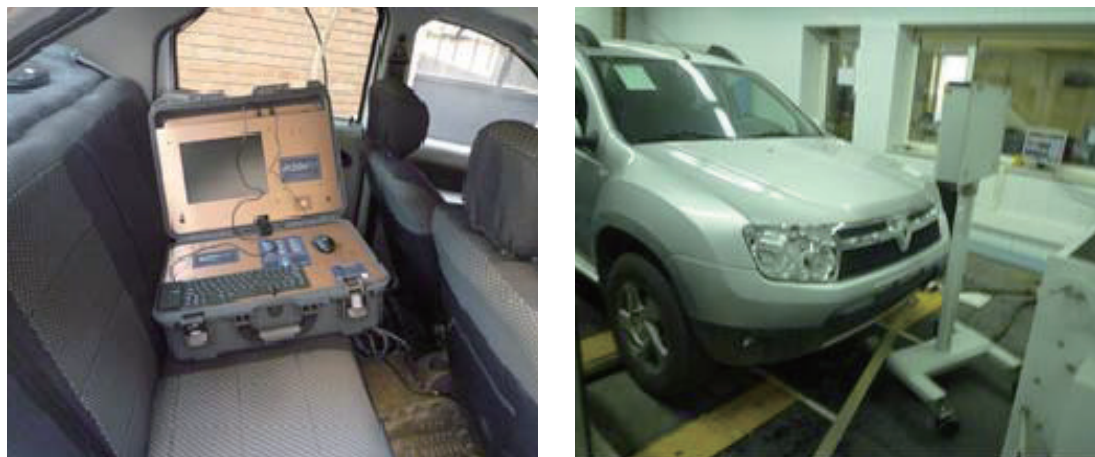
図 2-8 左：簡易型車載計（シャリフ工科大学）、右：セダン用シャーシダイナモ（SAIPA 社）
