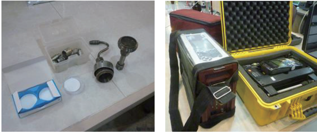
図 2 - 10 民間ラボ所有のばい煙測定機材
