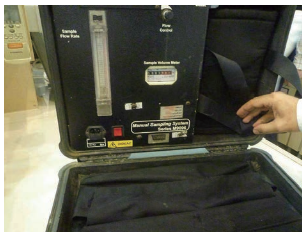
民間ラボ、工場排ガス採取装置（等速吸引） 2015 年 10 月 3 日
