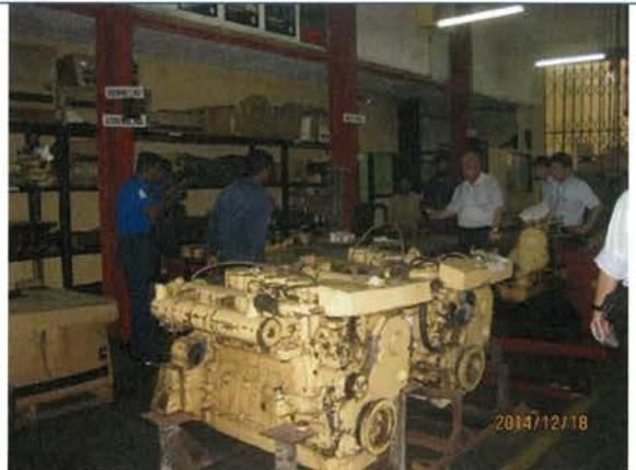
写真 3-4：SLN の CUMMINS 専用整備室。分解組立、調整、試運転が可能。なお、MTU、DEUTZ、MAN、YANMAR も同様に各地に SLN 専用整備場がある。
