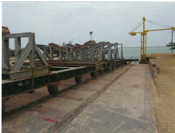
写真 4-12: SLCG 北部方面本部構内にあるスリップウェイ。23m 型 FPC 艇の修理作業は可能だが、30m 型新巡視艇の搭載にはサイズの的に不十分。
