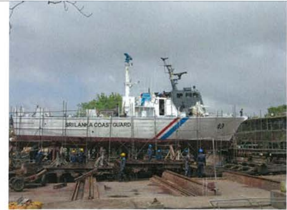
写真 4-5：トリンコマリの SLN 東部方面司令部のスリップウェイ。SLCG 北部方面本部所属 23m 型 FPC の修理中。同時 2 隻の修理作業可能。
