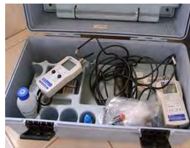
写真8 DO計、pH/EC/TDS計 右：DO計、左：pH/EC/TDS計 TDS (Total dissolved solid, 総溶解性蒸発残留物) はECから換算
