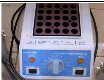
写真9 COD測定用の加熱器 (恐らく)
