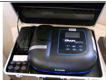
写真10 ポータブル式の吸光度計 このラボで一番稼働させている装置と推察。ほとんどの分析はこれで実施している。
