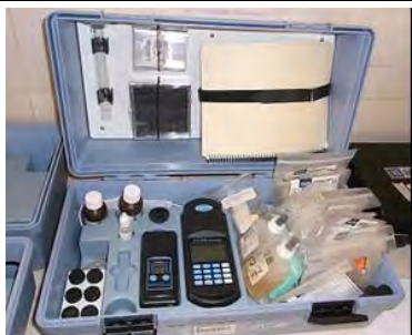
写真7 排水分析キット HACH 社 使用期限が過ぎているかもしれないが、試薬も揃っている。機器も稼働する。
