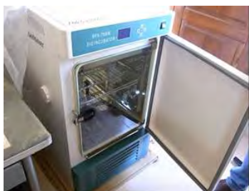
写真13 BOD用インキュベータ 恐らく、BOD用のみならず、一般的な培養に使用可能 (大腸菌の培養など)
