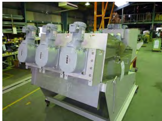
ヴァルト脱水機の脱水部分
