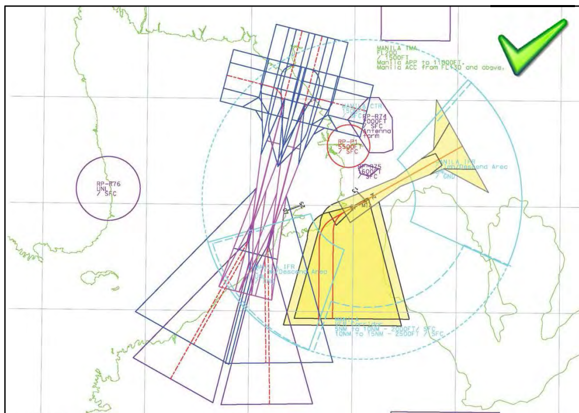
図 8.3.1-20 標準飛行経路保護区域図と現 NAIA の ILS-OAS との相対関係 (サングレーポイントオプション 1 : 西風時)
