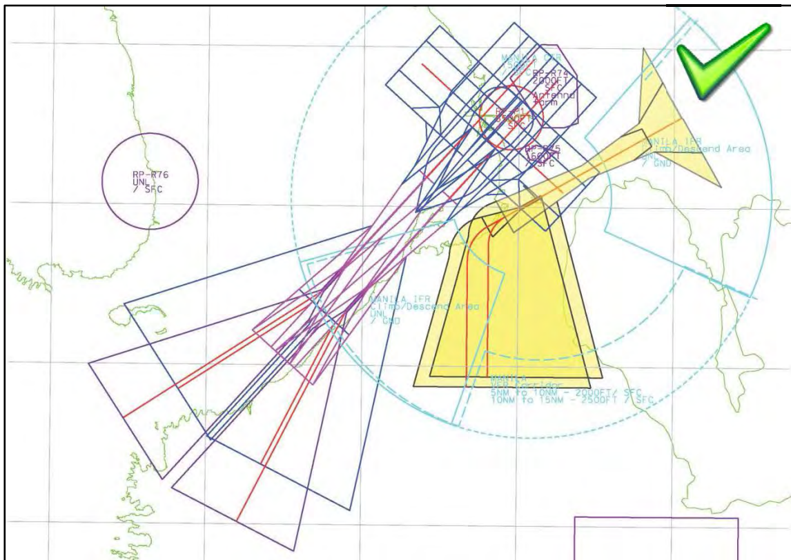
図 8.3.1-26 標準飛行経路保護区域図と現 NAIA の ILS-OAS との相対関係 (サンニコラスショールズ：西風時)
