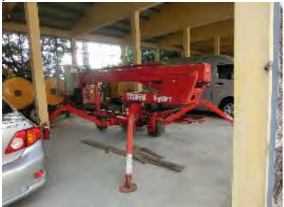
スパイダーリフト 使用用途不明
