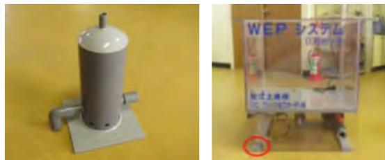
図 3-1 気液溶解装置模型
