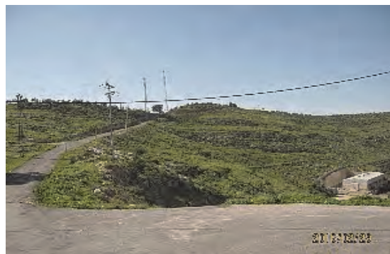
T/S は前方の小山を超えたところにある。アクセス道路は急峻でかつ幅が狭い。大型車両の走行は非常に危険。
