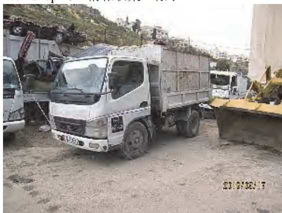
小型収集車輛（道路が狭いため有効な機材）
