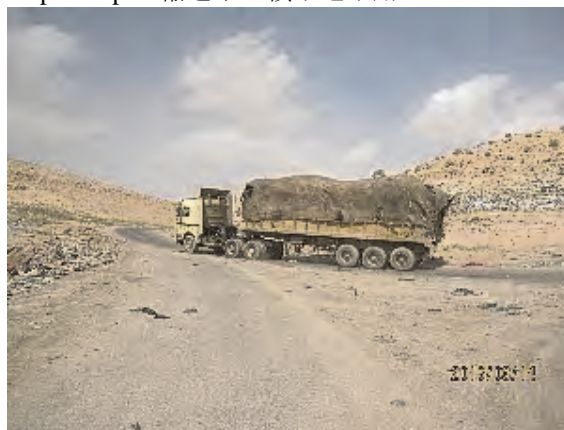
中継輸送用の Open top trailer (ホローを掛けてごみの飛散を防いでいる)
