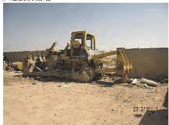
故障して放置されたブルドーザ
