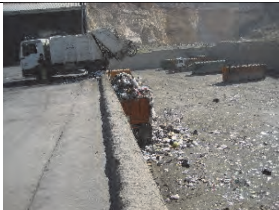
直接積み替えるシステム
