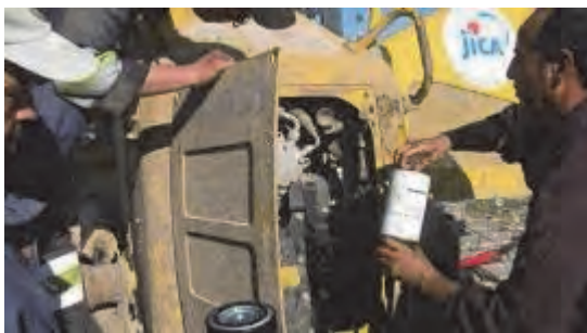
フィルター等の定期交換
