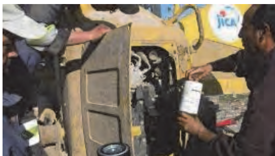
フィルター等の定期交換
