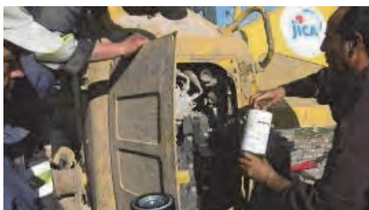
フィルター等の定期交換
