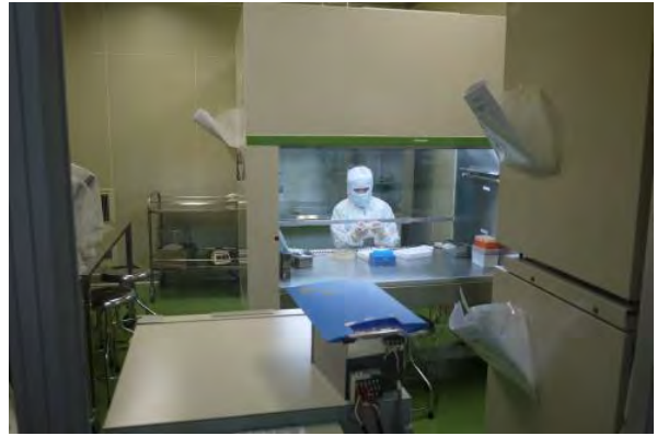
安全キャビネット（供与機材）での作業
