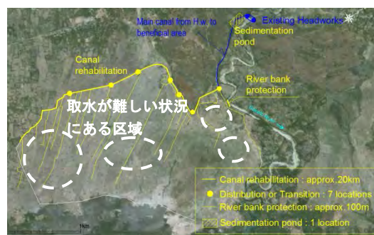
図 4-7-4 支線用水路の状況
