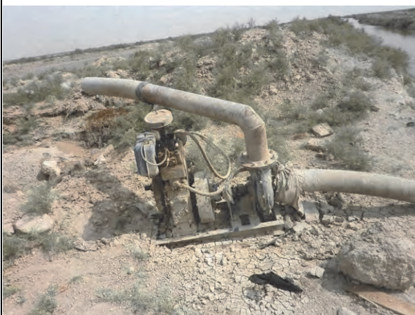
Piet Ghzayel WUA 農民は個人ポンプにより自己の圃場に送水を行って いる。(Basrah 県)
