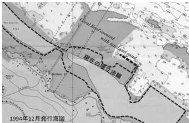
図 2-2-4(8) 過去の海図と現在の埋立法線
