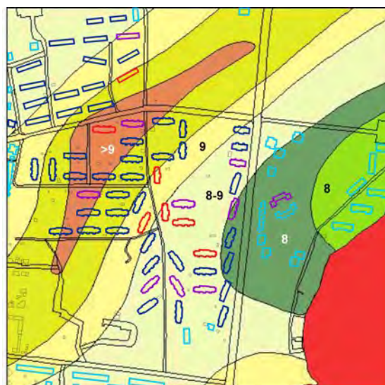
図 6.14 エレバン市 Achapnyak 区のリスクマップ (集合住宅の被害程度 (赤いほど被害大))
