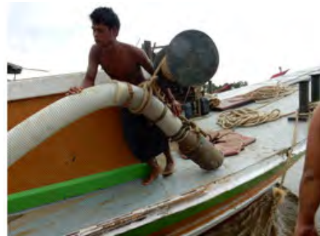
小型ポンプ船に搭載される スクリューポンプ
