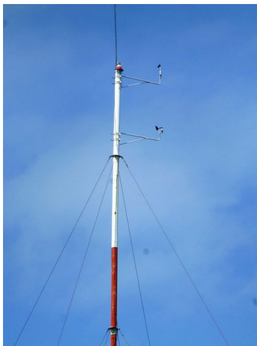
Figura 7.2.2-2 Instrumento de observación de condiciones de viento en el sitio piloto de Turiguanó (a 50m sobre la tierra)
