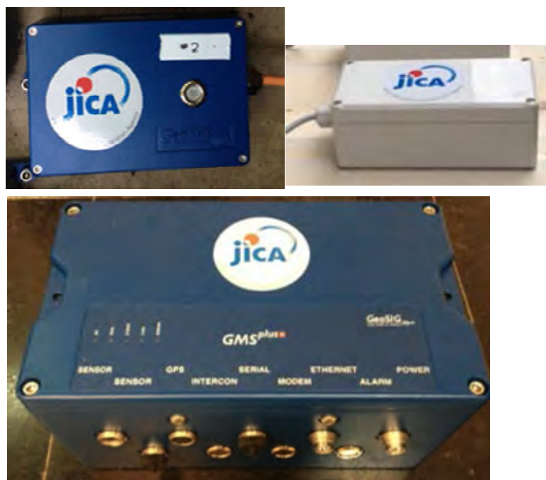
شکل 184.2 تجهیزات اهدایی جهت ثبت زمین لرزه سمت چپ بالا: سنسور، بالا سمت راست GPS، پایین: کنترل ها
