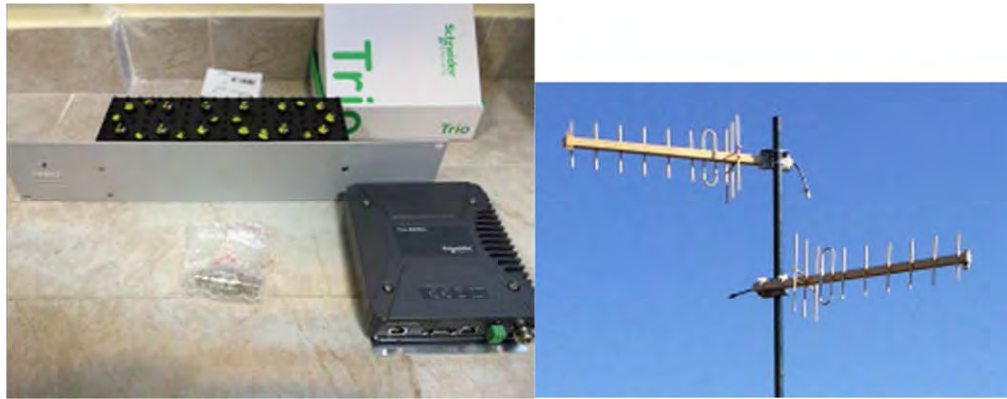
شکل 2.14.2 تجهیزات ارتباطی (سمت چپ بالا: جدا کانال، مرکز: رادیو (ER45e)، راست: آنتن یاگی)
