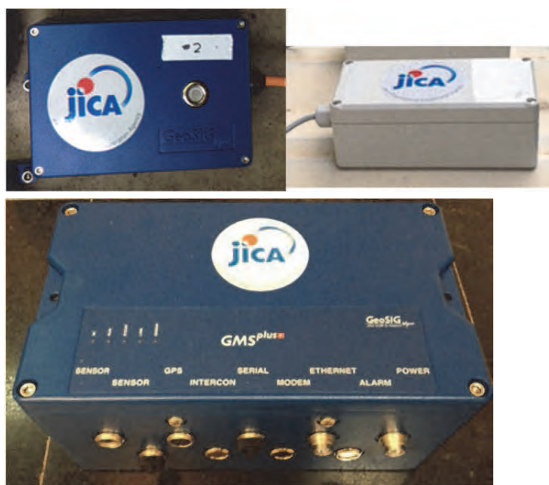
図 2.4.18 供与した地震観測機材 (左上:センサー、右上:GPS アンテナ、下:処理器)
