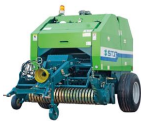
Otların qablaşdırılması üçün orta ölçülü kəsmə texnikası IHI Star şirkəti
