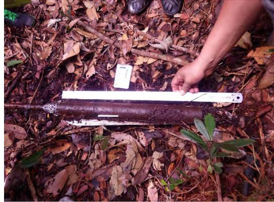
Fig. 12 不攪乱泥炭試料の採取.
