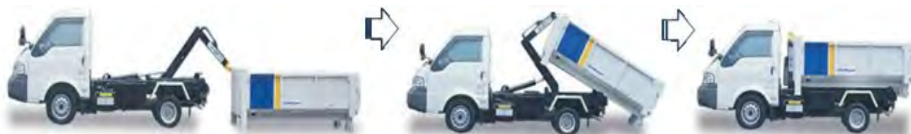
図 2-10 アームロール車による直方体コンテナのローディング状況
