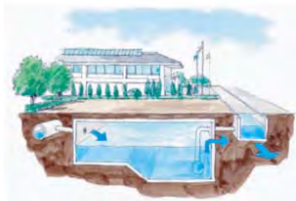
a) 雨水地下貯留槽
