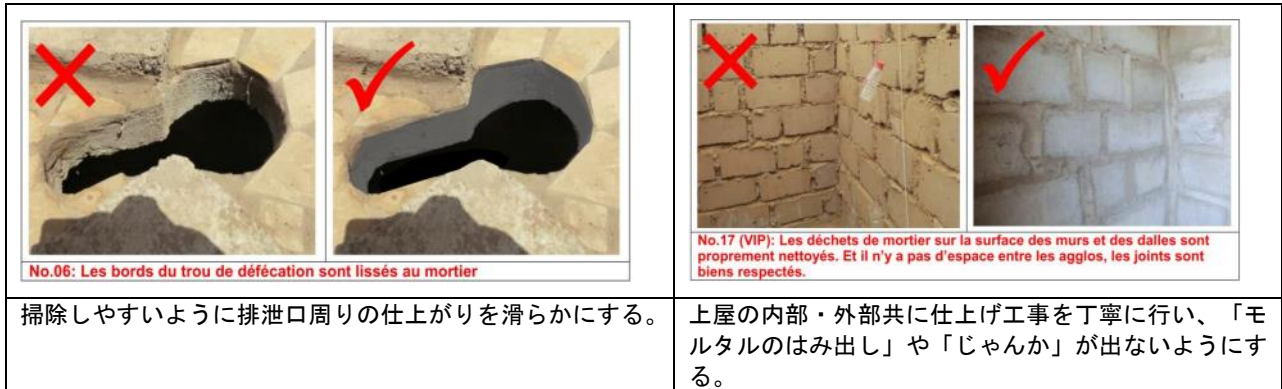
図 2-5 「施工品質確認シート」の一例
