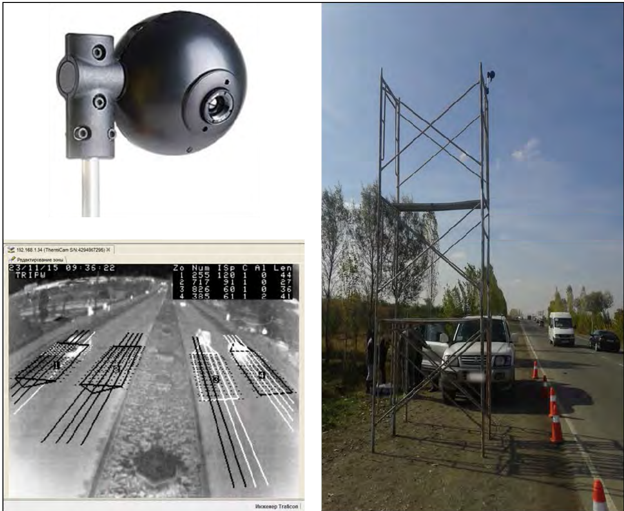
図 5.2-1 赤外線サーマルカメラを用いた 24 時間スクリーンライン調査
