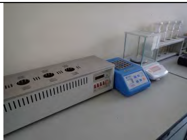
ケルダール分析装置の一部 (左)、 CODリアクター (中央)、電子天 秤 (右)
