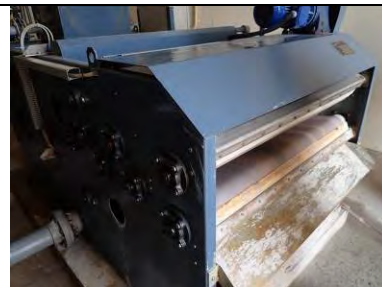
スラッジ処理装置
