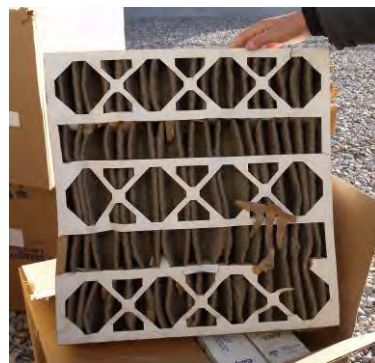
図 3-6 4 カ月使用後の吸気フィルタ
